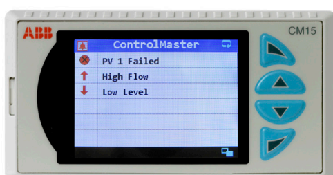
Figura 4 Pantalla de estado de alarma
