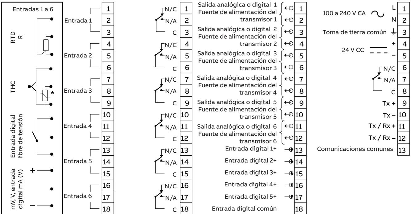
\* Cada entrada de termopar debe contar con un conjunto de juntas frías (número de pieza CM30/0052) o un puente de cortocircuito (número de pieza RVG200/0118) instalado. Cada tarjeta de entrada analógica con entrada termopar debe tener como mínimo un conjunto de juntas frías instalado. En el caso de aplicaciones que requieran máxima precisión de termopar, se recomienda que cada entrada de termopar disponga de un conjunto de juntas frías.
