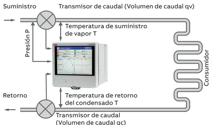
Figura 7 Ecuación energética de equilibrio de potencia de vapor
